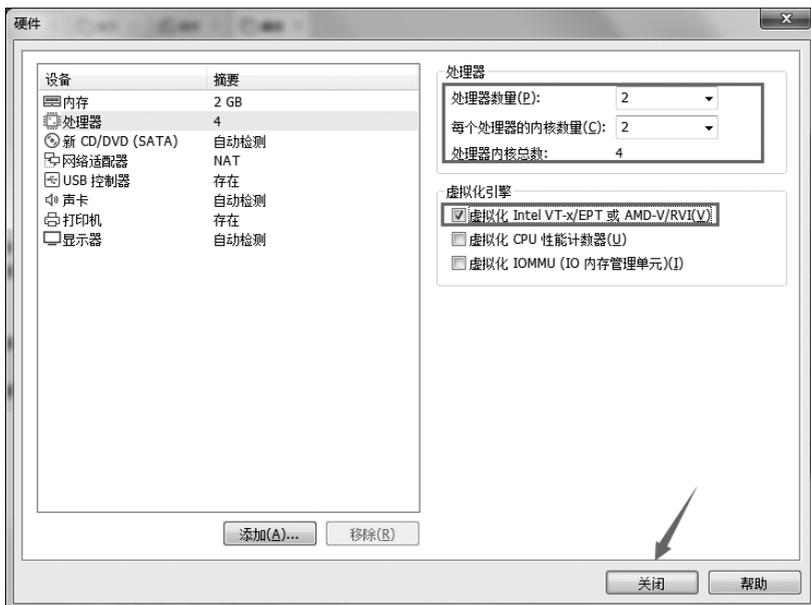
图 1-10 设置虚拟机的处理器参数
