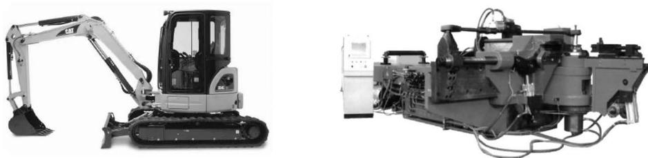
图 5-2 采用双回路液压伺服系统的挖掘机和弯管机
