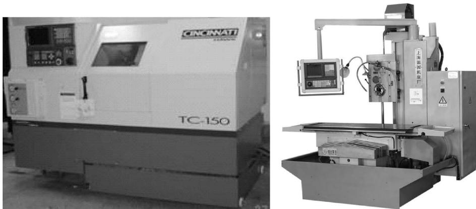
图 5-3 采用直流伺服电动机控制系统的数控车床和镗铣床
