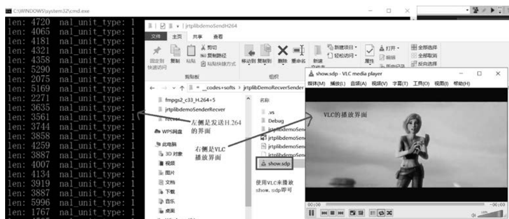
图 3-30 JRTPLIB 发送 H.264 码流后用 VLC 播放
