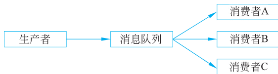
图 5-5 发布/订阅消息传递模式结构
