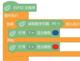
图21-4 Mini巡线传感器的测试程序
