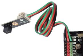
图21-2 Mini巡线传感器电路连接
