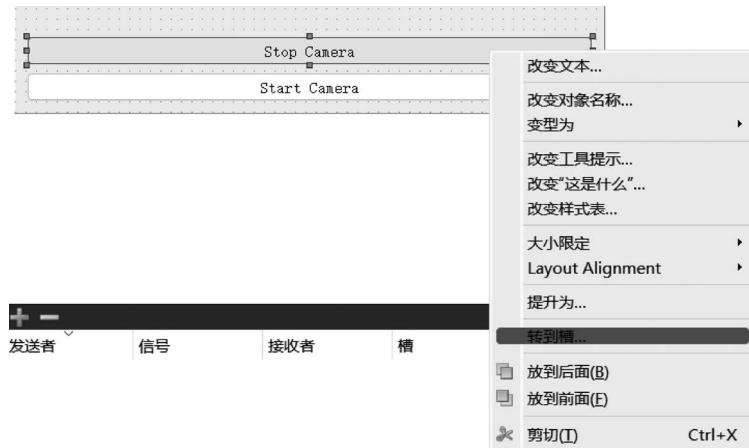
图 3-25 为 QPushButton 添加槽函数
