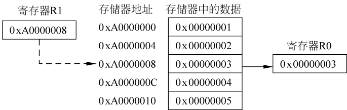
图 3-1 寄存器间接寻址方式示意图
