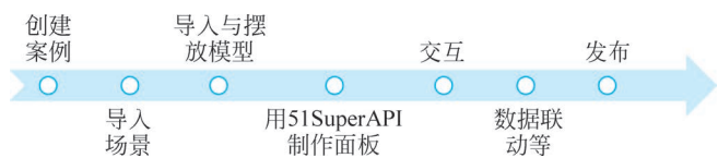
图 3-12 WDP 低代码开发流程
