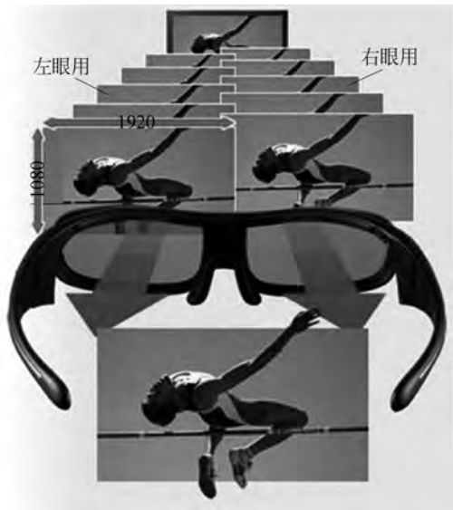
图 3.11 分时技术原理
