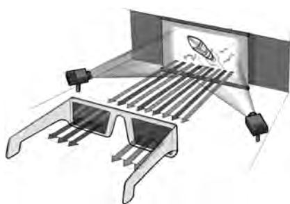
图 3.10 分光技术原理
