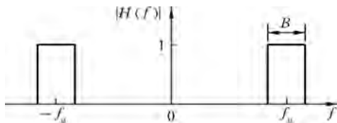
图 3-25 带通滤波器的传递函数
