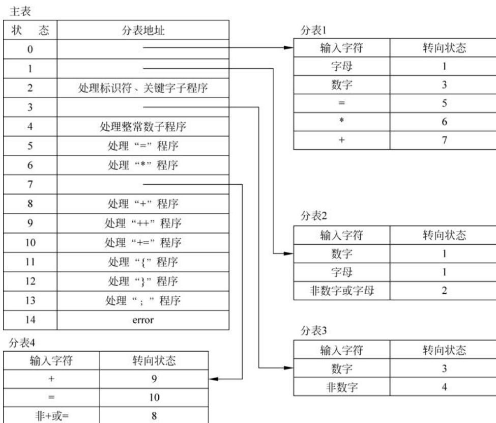
图 3-18 状态转换图的二级目录表
