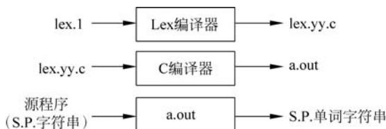
图 3-20 用 Lex 自动生成一个词法分析器流程
