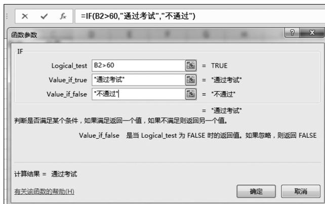
图 5-13 设置 IF 函数参数
