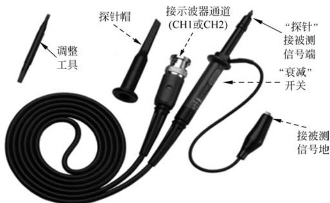
图 3-32 示波器测试探头(测试线)
