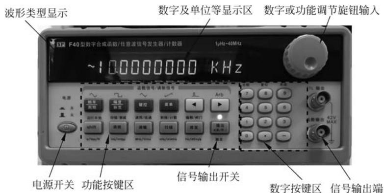
图 3-17 F40(80)函数信号发生器前面板
