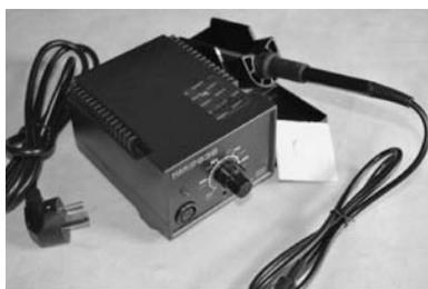
图 3-3 恒温式电烙铁
