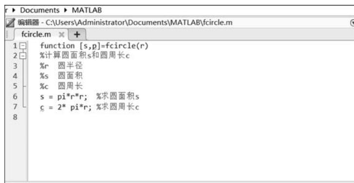
图 5-3 在编辑器中编写函数
