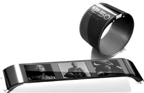
图 3-10 可弯曲的智能可穿戴外置设备
