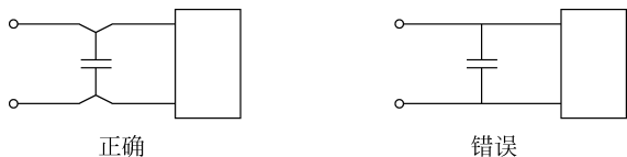
图 5-2 电容靠近负载的电源管脚
