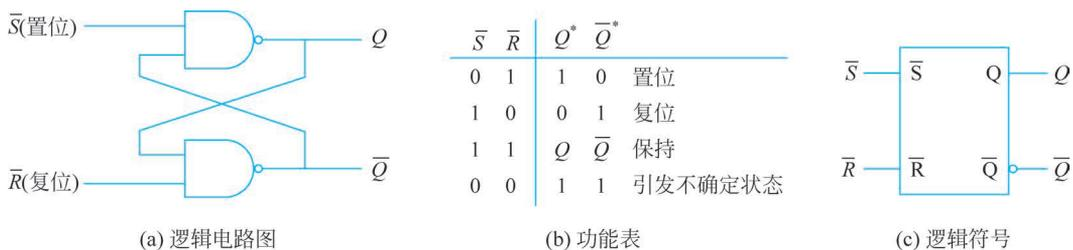
图 5-3 与非门构成的  $\bar{S}\bar{R}$  锁存器
