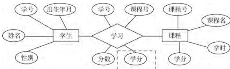
图 3.17 消除 E-R 图中的冗余信息示例
