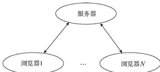
图 1-2 B/S 体系结构示意图
