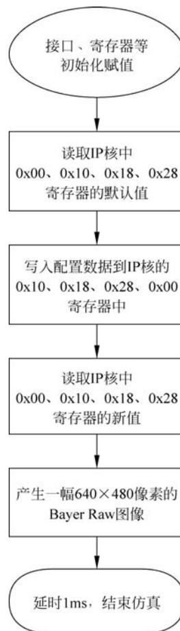
图 5.11 Sensor Demosaic IP 核仿真流程图
