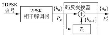
图 5-13 2DPSK 信号相干解调码变换系统性能分析模型
