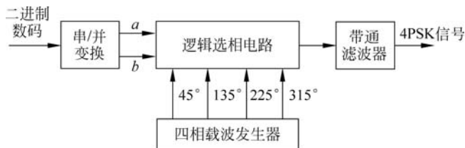
图 5-23 相位选择法产生 4PSK 信号(B 方式)框图
