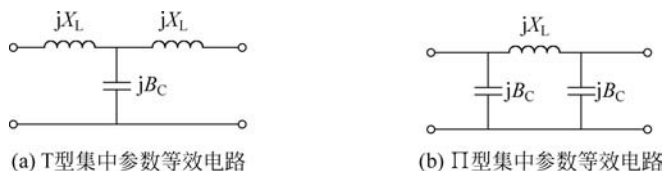
图 3.3-19 传输线段的集中参数等效电路
