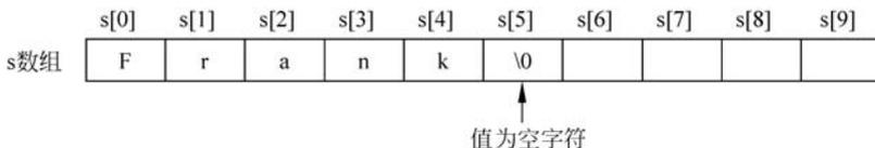
图 5-23 对字符数组正确赋值后的存储示意图
