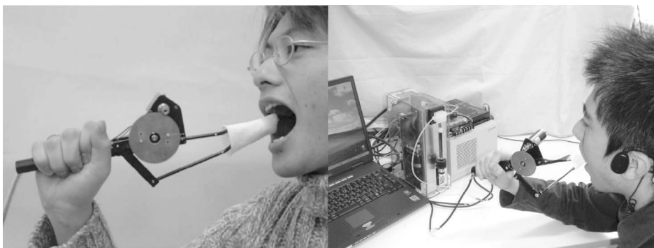
图 5.16 用户体验产生味觉反馈的电动机械设备
