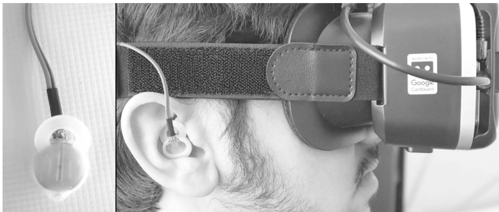
图 5.5 面向聋哑人士和听力障碍人士提供的面部触觉反馈设备
