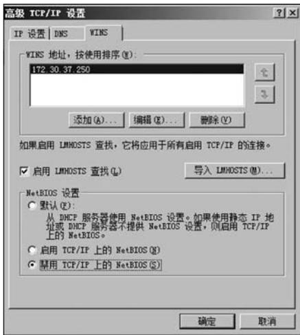
图 3.6 关闭 139 端口
