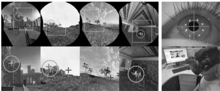
图 5.11 眼动跟踪模型 DGaze 对头戴式显示器中用户的注视点进行预测
