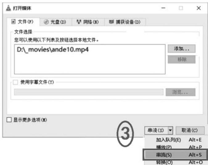
图 3-5 VLC 流媒体服务器之添加串流协议
