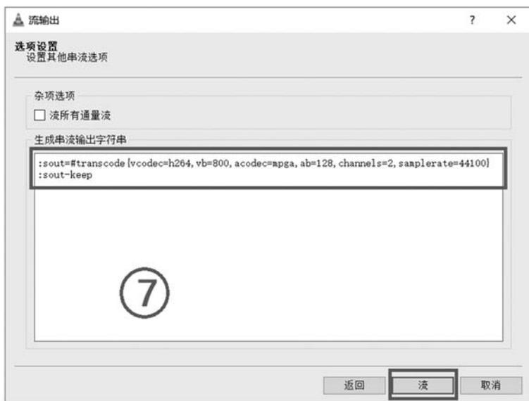
图 3-9 VLC 流媒体服务器之串流输出参数字符串
