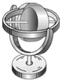
图 3-5 单自由度陀螺仪
