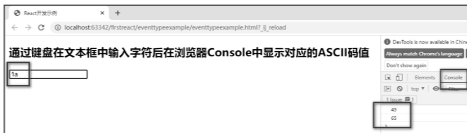
图 3-18 通过键盘在文本框中输入字符后在浏览器 Console 中显示对应的 ASCII 码值
