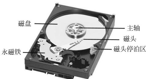
图 3-20 机械硬盘内部结构
