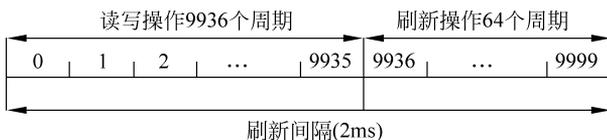
图 5.3 集中刷新方式示意图
