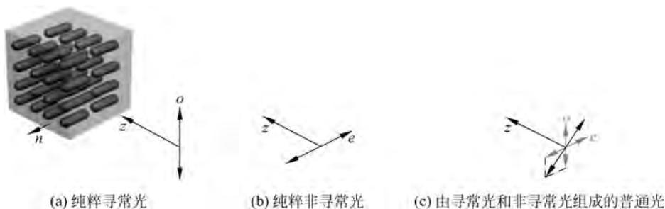
图 3.3.14 线偏振光以  $\alpha=90^\circ$ 角进入液晶介质
