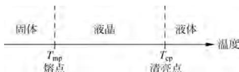
图 3.2.1 热致液晶的温度范围在熔点与清亮点之间
