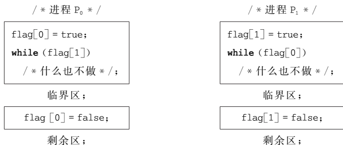
图 3-7 双标志、先修改后检查算法
