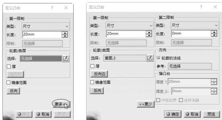
图 3-12 “定义凸台”对话框
