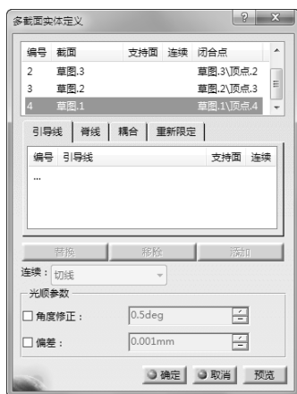
图 3-53 “多截面实体定义”对话框
