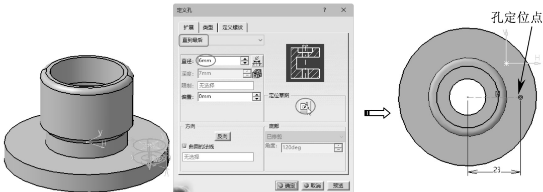
图 3-69 创建孔的定位约束
