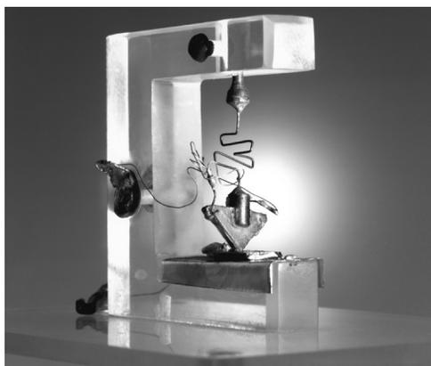
图 1.2 第一个锗双极型晶体管(图片由阿尔卡特-朗讯提供)
