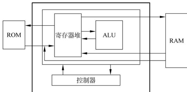
图 3-6 CPU 结构
