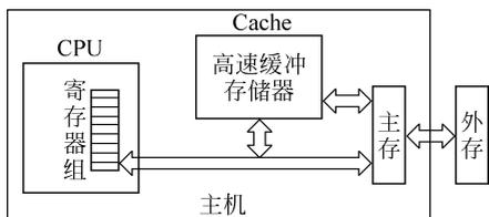
图 3-7 多级存储器体系结构
