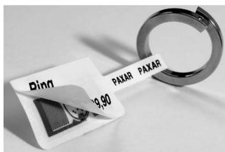
图 3-18 RFID 电子标签
