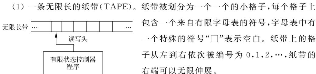
图 3-1 图灵机模型
