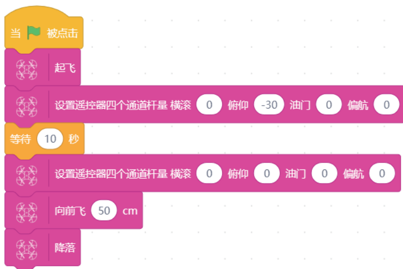
图 2.9.2 无人机飞抵墙壁的探究程序
