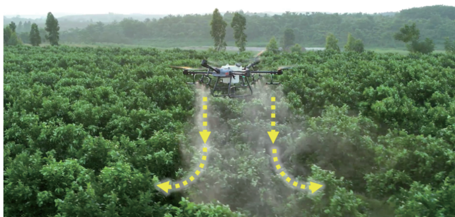
图 2.7.10 螺旋桨产生的下压气流
