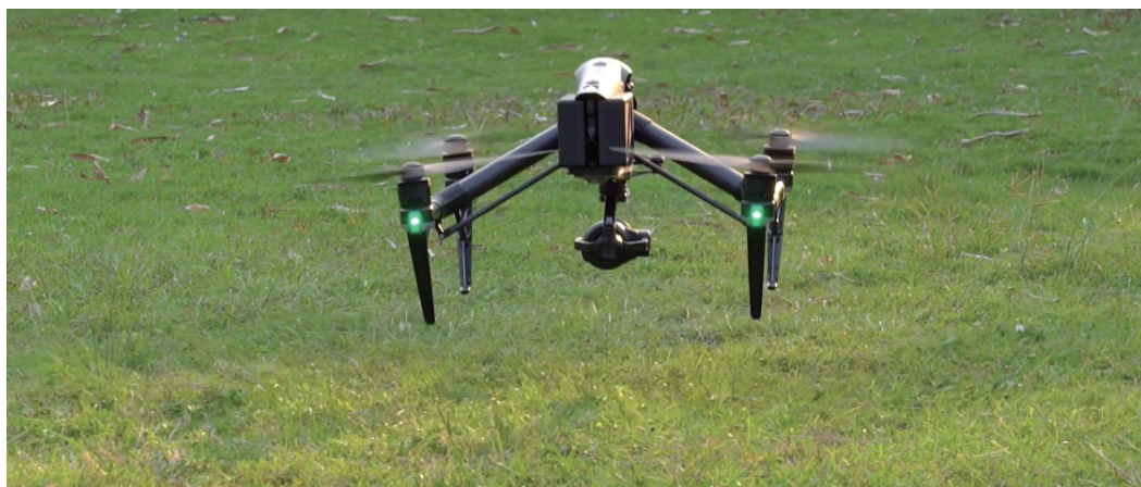
图 2.9.6 具有多个冗余系统的无人机
