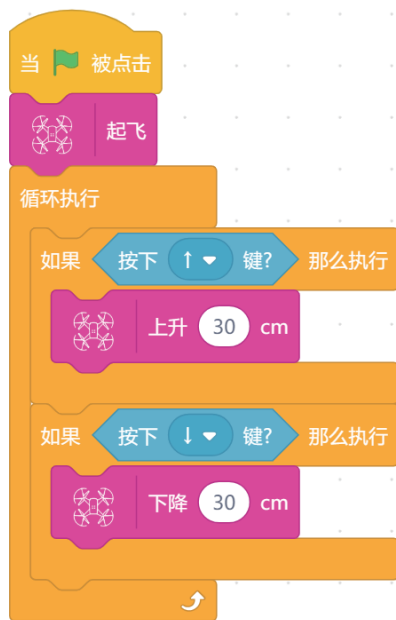
图 2.2.18 使用“按下_键？”模块编程的程序
