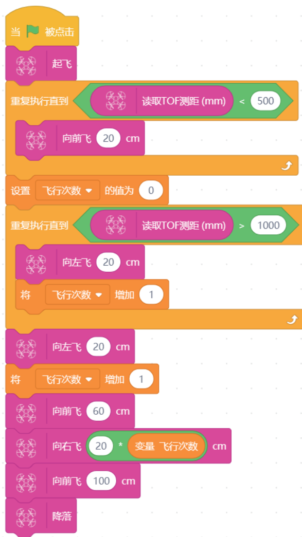
图 2.4.12 无人机越障的程序
