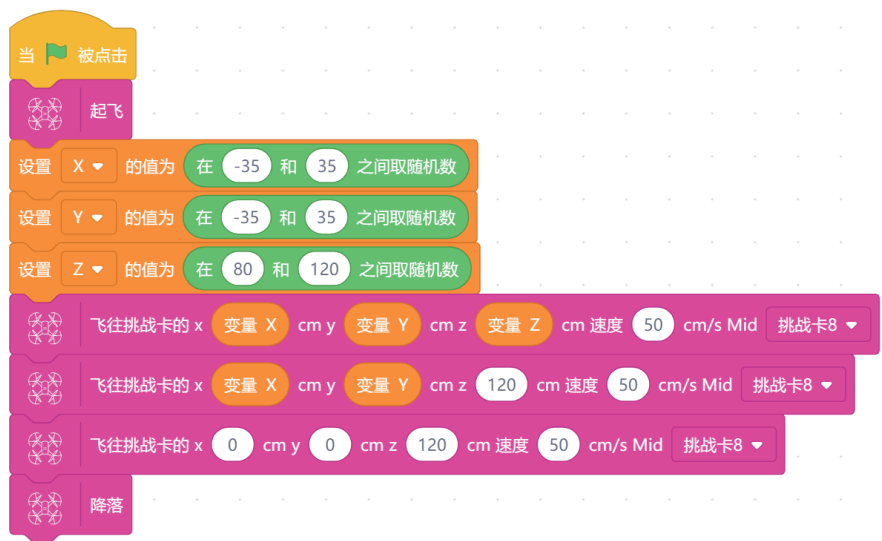
图 2.11.5 无人机坐标返航的程序
