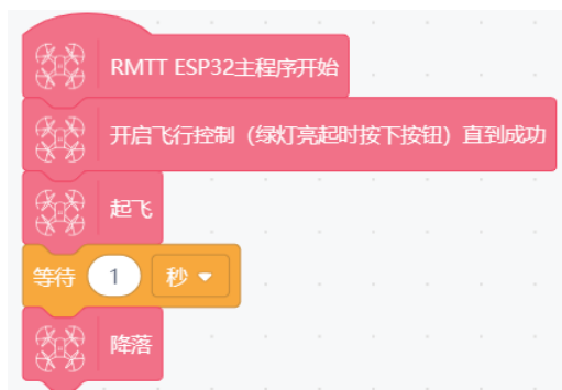
图 2.2.12 上传模式下的无人机起飞程序
