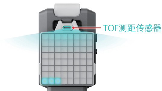
图 2.1.15 拓展模块上的 TOF 测距传感器
