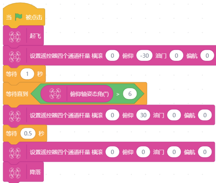
图 2.9.3 无人机接触式避障程序
