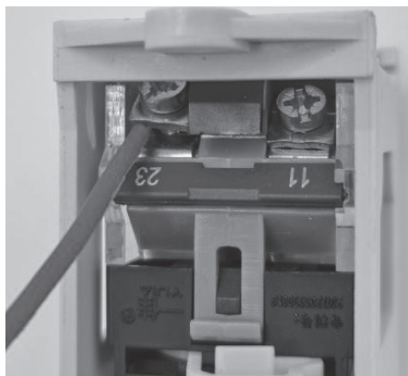
图1-25 警示灯与自锁式控制按钮的连接
