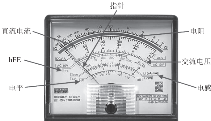
图1-32 指针式万用表表头
