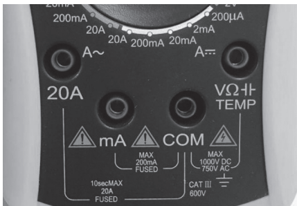
图1-34 输入电流、电压注意点
