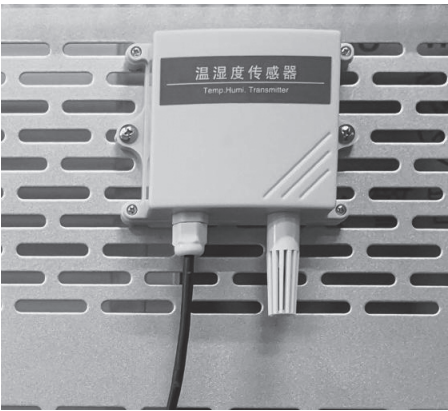
图1-44 温湿度传感器安装效果
