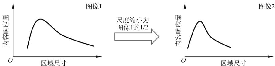
图 5-3 与图像尺度协变的内容响应曲线示例
