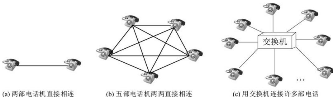
图 1-8 电话机的不同连接方式
