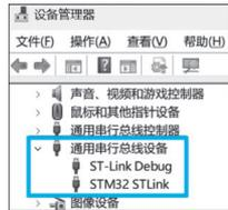
图 3.27 设备管理器中的 ST-LINK 设备
