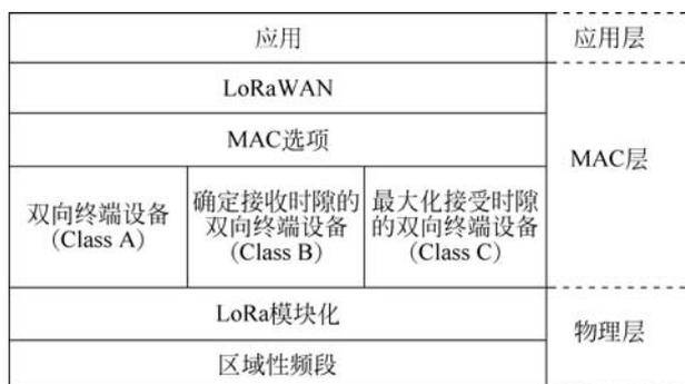
图 5-9 LoRa 与 LoRaWAN 的层次关系
