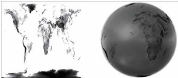
图 3-7 环境光遮挡贴图可以产生自我遮挡的效果
