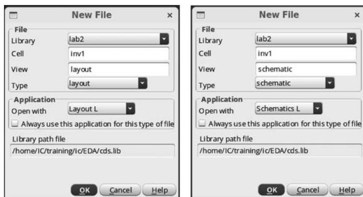
图 5-16 建立新单元的版图及电路图
