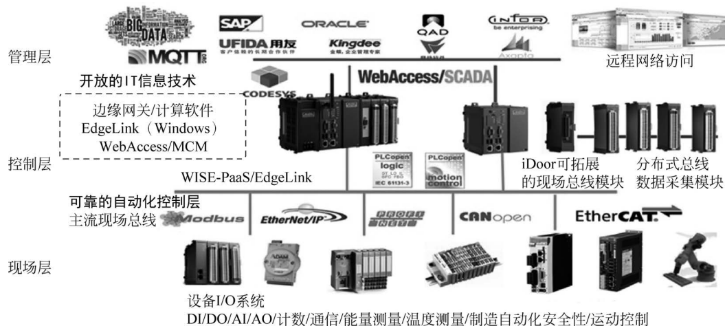
图 5-32 APAX-5580 边缘智能控制器优势整合 PLC 控制+设备联网的应用实例
