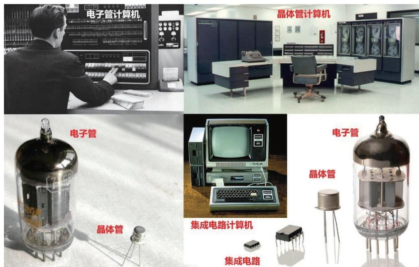
图 3-8 电子管计算机、晶体管计算机和集成电路计算机
