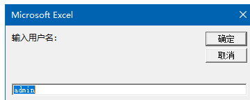
图 1-25 由 InputBox 函数创建的对话框
