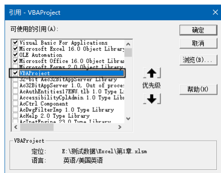
图 1-31 在一个 VBA 工程中引用其他 VBA 工程
