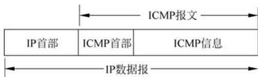
图 5-1 ICMP 报文的 IP 封装
