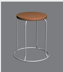
01 启动3ds Max 2020，在“创建”面板的“几何体”下拉列表中选择“扩展基本体”选项，然后单击“切角圆柱体”按钮，在透视图图中创建一个切角圆柱体作为凳面，如图3-27所示。
