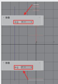
10 在“创建”选项卡的“几何体”下拉列表中选择“复合对象”，单击“放样”按钮，在创建方法下单击“获取路径”按钮，选择最开始创建的直线作为路径，然后单击“获取图形”按钮，选择最上方的圆圈Circle009作为第1个截面，此时放样效果如图3-173所示。
