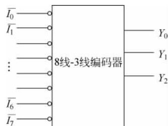
图 3-26 8 线-3 线编码器示意框图
