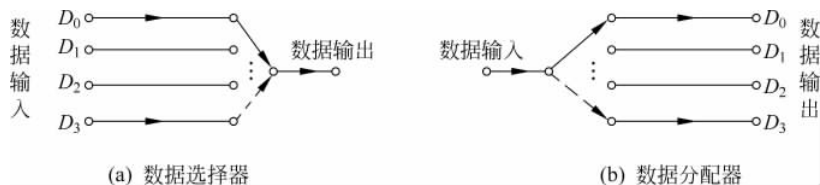
图 3-45 数据选择器和数据分配器的功能示意图
